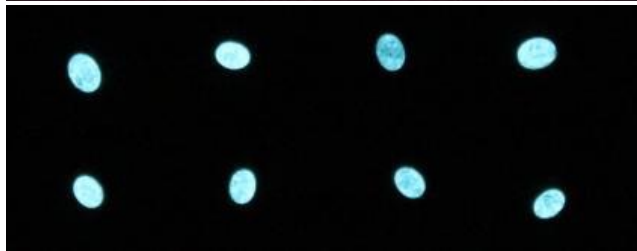
照射前のHPHT合成サンプルの蛍光（上）と燐光（下）
