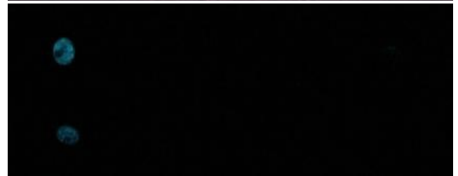
照射後のHPHT合成サンプルの蛍光（上）と燐（下）
