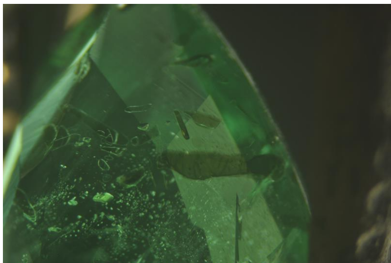
エチオピア産のエメラルドに見られるマイカ（雲母）のインクルージョン
